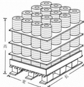
•请将玻璃纤维产品存放于干燥和凉爽的环境中，建议温度控制在10-30°C，湿度控制在50-75%。托盘堆高不大于2层。
